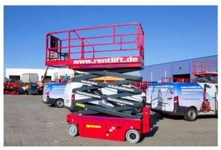
Die elektrische Scherenarbeitsbühne mit einer Arbeitshöhe von 9,92 Metern und einer Baubreite von ca. 1,17 Metern ist mit hochmoderner Technologie ausgestattet, um anspruchsvolle Höhenarbeiten zu bewältigen. Sie bietet eine beeindruckende Traglast von 454 kg, was ausreichend Platz und Stabilität für den Transport von Personen und Materialien ermöglicht.
