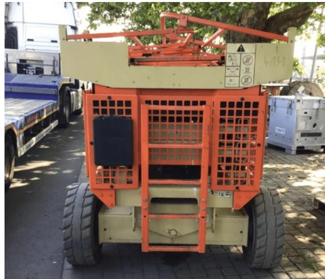
Die JLG 3369 LE ist eine elektrische Scherenarbeitsbühne des renommierten Herstellers JLG mit einer Arbeitshöhe von 12 Metern und einer Baubreite von ca. 1,75 Metern. Mit einer Traglast von 450 kg bietet sie ausreichend Platz und Stabilität für Materialien und Bediener.
