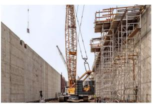
max. Traglast: 750.00 t 36,00 - 180,00 m max. Hubhöhe: max. Ausladung: 108.00 m max. Traglast bis Ausladung: 9.00 m max. Hubhöhe (mit Gitterspitze): 204,00 m max. Gitterspitze: 18,00 - 102,00 m Fahrgeschwindigkeit: 1,20 km/h **Gesamtballast:** 680,00 t Raupenfahrwerk:
