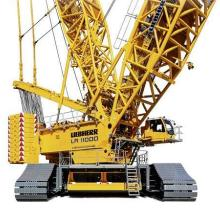
max. Traglast: 1350.00 t max. Hubhöhe: 30,00 - 150,00 m max. Ausladung: 92.00 m max. Traglast bis Ausladung: 12,00 m max. Hubhöhe (mit Gitterspitze): 196,00 m max. Gitterspitze: 12,00 - 114,00 m Fahrgeschwindigkeit: 1,08 km/h **Gesamtballast:** 990.00 t Raupenfahrwerk: Ja
