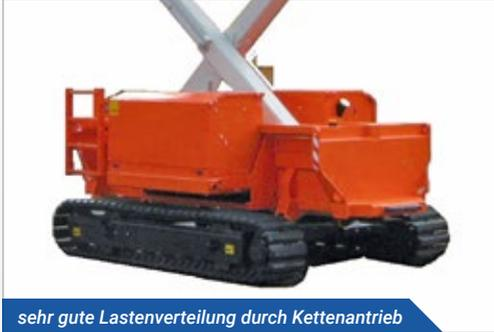
sehr gute Lastenverteilung durch Kettenantrieb
