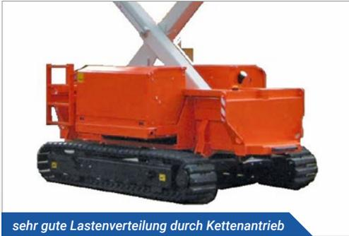
sehr gute Lastenverteilung durch Kettenantrieb
